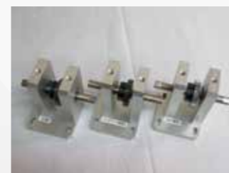
歯車・軸受損傷 による異常
