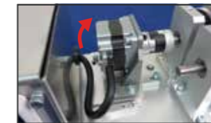
▲基点軸を中心に矢印方向に移動
