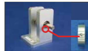
▲アンギュラベアリングの外輪にφ3mmの穴（一ヶ所）があいている
