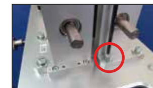
▲各ユニットの取付ネジを緩める
