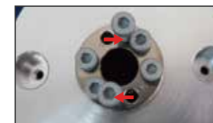
▲ネジ2本を取外し用のネジ穴に移設
