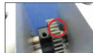
▲ギアの歯の一つが欠落している
