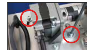
▲モータベースの固定ネジを緩める
