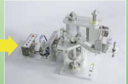
モジュール組合せ例：揺動空気圧モータとクロックの回転動作
