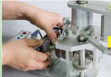
モジュール組合せ例：揺動空気圧モータとクロックの回転動作
