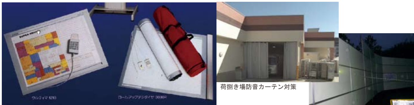
音源座標の取り込み用デジタイザ 規模に応じて2サイズ (A3 A2版)
