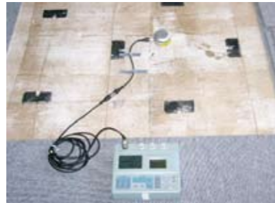
建物内の鉄道振動無人測定状況
