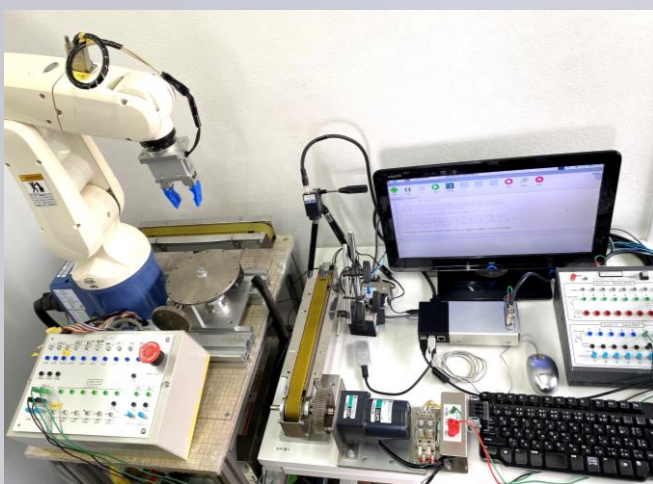
AIを使用したラズベリーパイによるMM3000の制御
